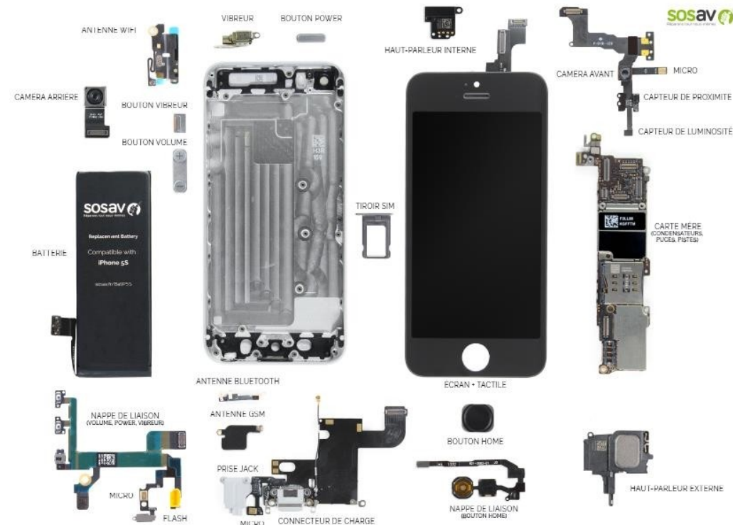
Vue éclatée d'un smartphone avec ses différents composants.
